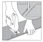
Ouvertures pour les tuyaux : Mesurer le diamètre du tuyau et percer un trou de 20 mm plus large. Scier un morceau et placer la lame sur le sol. Puis remettre le morceau scié en place.
