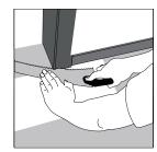
Encadrements de portes et plinthes : Placer une lame avec la partie inférieure dirigée vers le haut contre l'encadrement de la porte. Scier l'encadrement de la porte comme indiqué sur l'image. Puis poser la lame en dessous de l'encadrement de porte scié.
